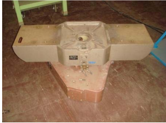
写真 7 AZ 軸にヨークベースを載せた所
