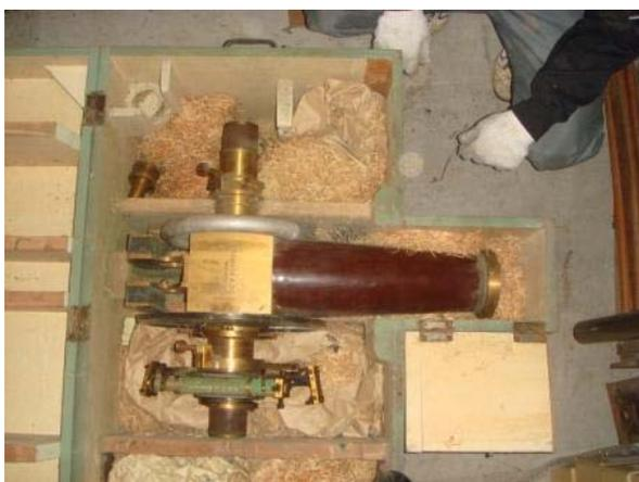
写真1 発見された経緯儀の望遠鏡部
