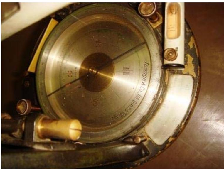
写真4 トランシットの水平軸目盛環
