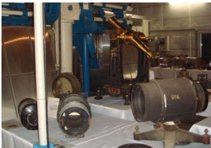
写真 7 タワーの分光器のカメラレンズなど
