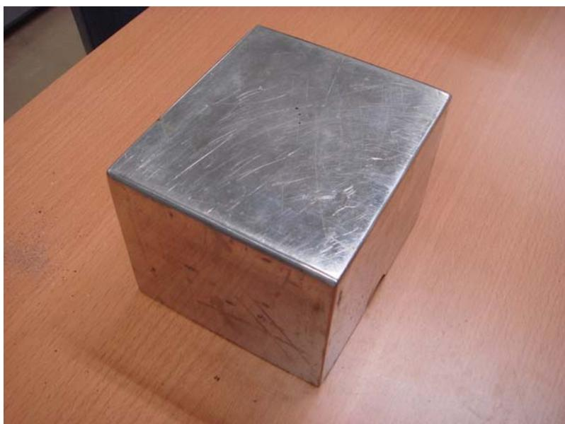
写真1 ステンレス製の乾板増感ベーキング箱
