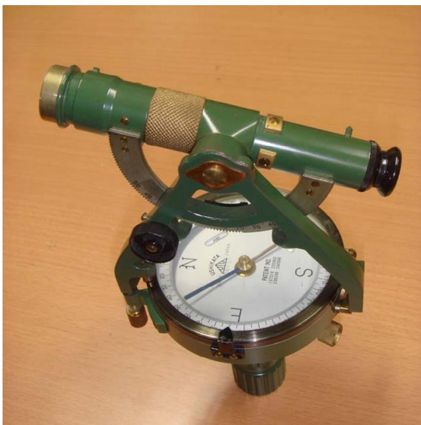
写真1 玉屋牛方式ポケットコンパス
