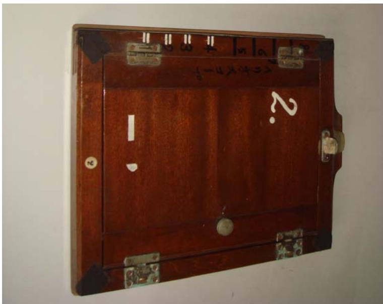
写真1 八つ切り写真乾板取り枠
