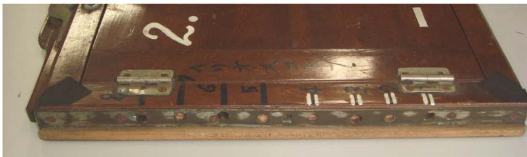
写真4 取り枠を8箇所固定する工夫
