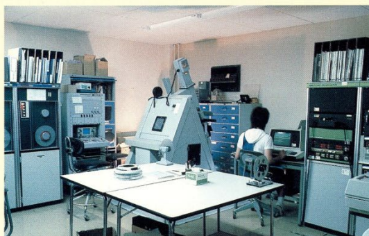
アイソフォトメータ(中央)と制御用計算機(左)。右側にデータ処理用計算機。
