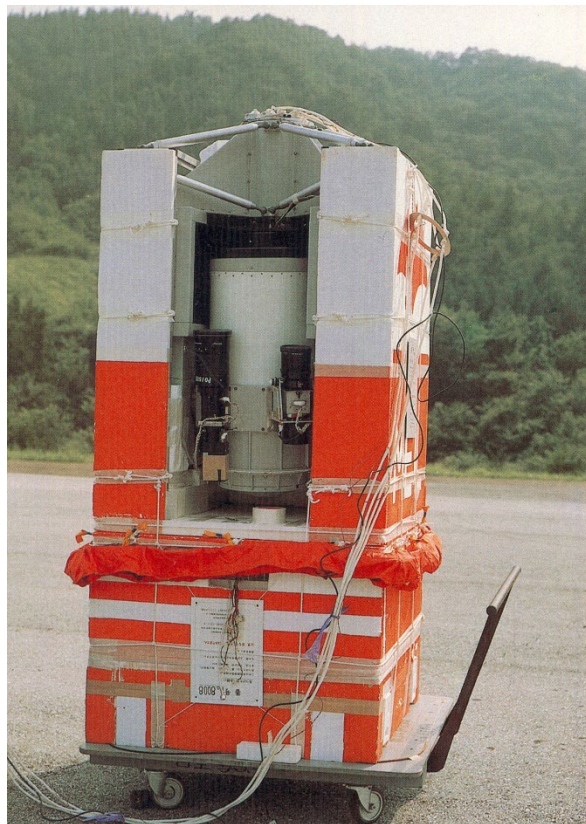
写真 2 気球搭載用赤外線望遠鏡「BAT II」
