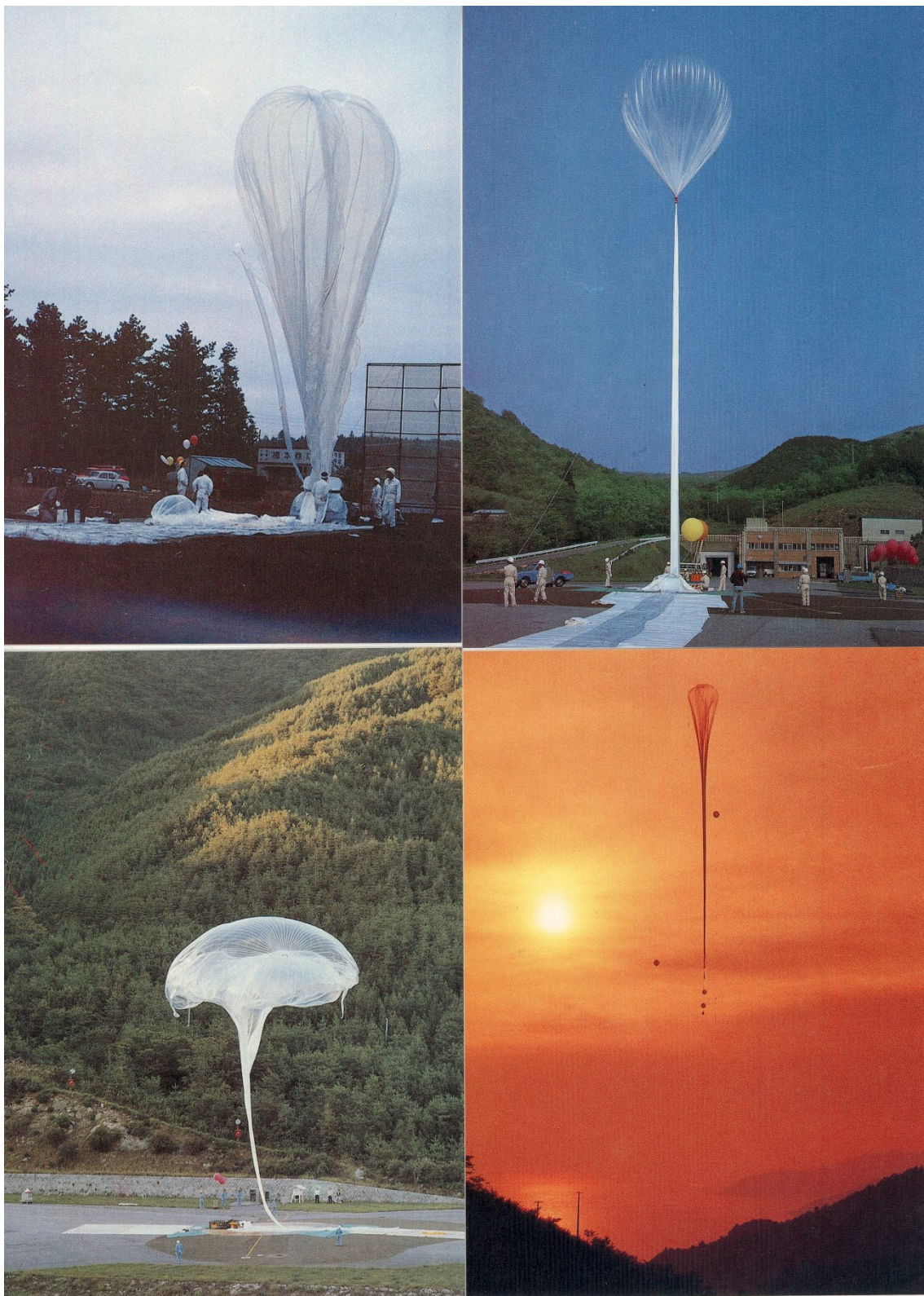
写真4 左上はヘリウムガス充填中、右上は充填の最終段階 左下は放球の瞬間、右下は上昇中の観測気を吊下げた気球
