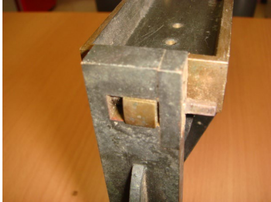
写真8 平行度の調整ねじ
