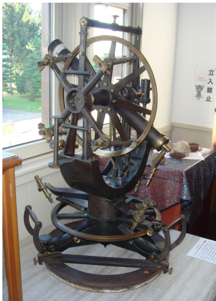
写真3 18吋トロートン・シムス経緯儀と分かった水沢のもの
