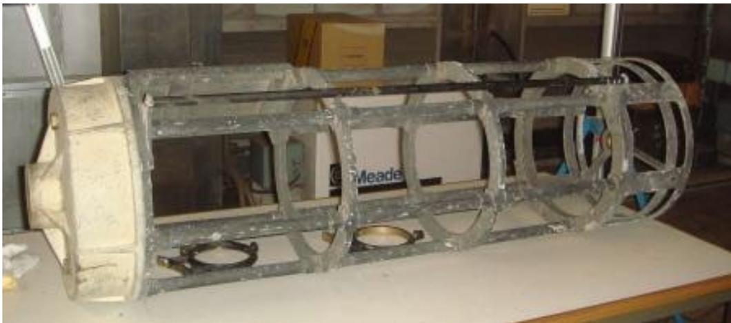
写真4 天文機器資料館に収蔵の30cm反射望遠鏡の筒
