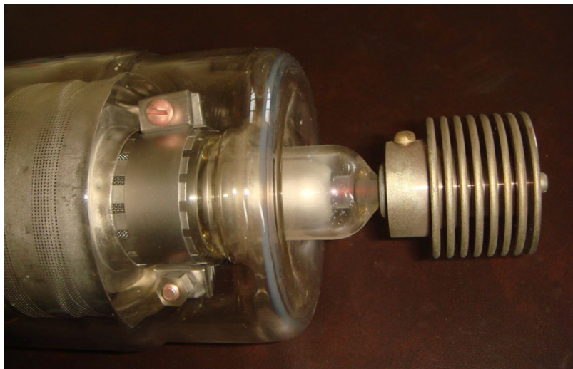
写真6 真空管の先端部
