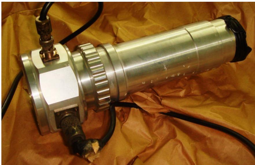
写真6 光電子増倍管のハウジング
