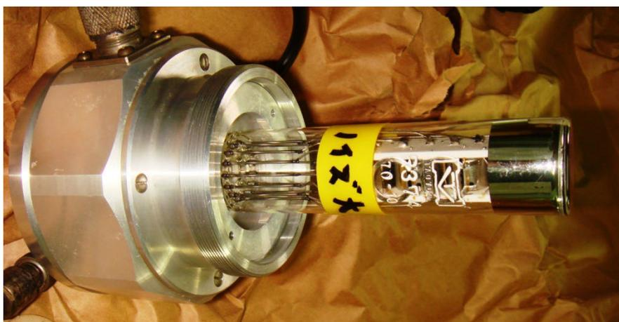
写真7 ヘッドオンの光電子増倍管
