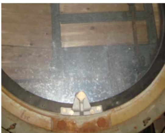
写真1 ひどい反射面の平面鏡
