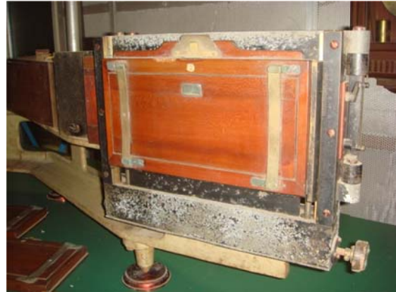
写真8 ティルト調節機構
