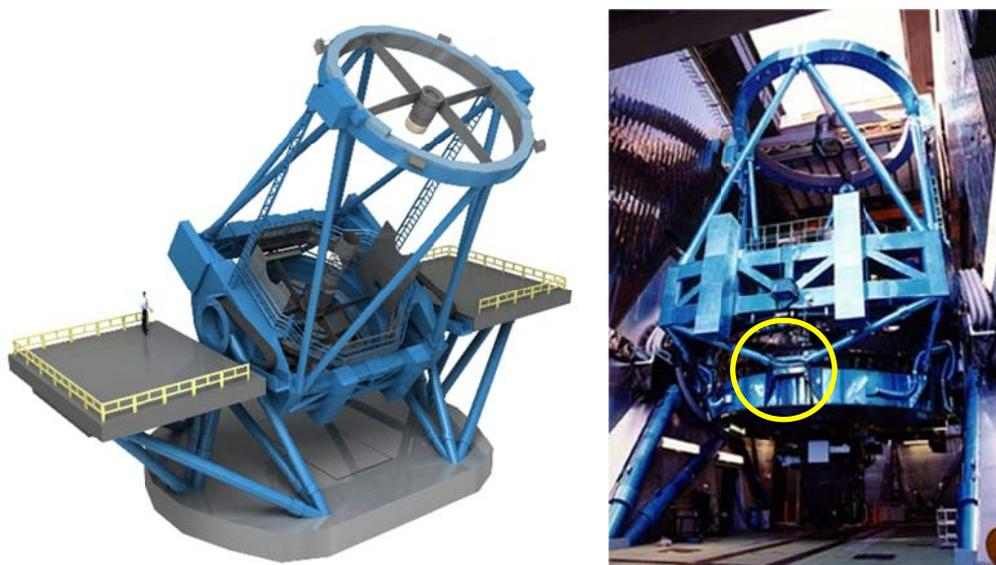
写真1 大型光学赤外線望遠鏡「すばる」の構造
