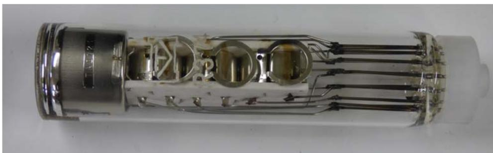
写真1 浜松フォトニクス製 光電子増倍管 R3
