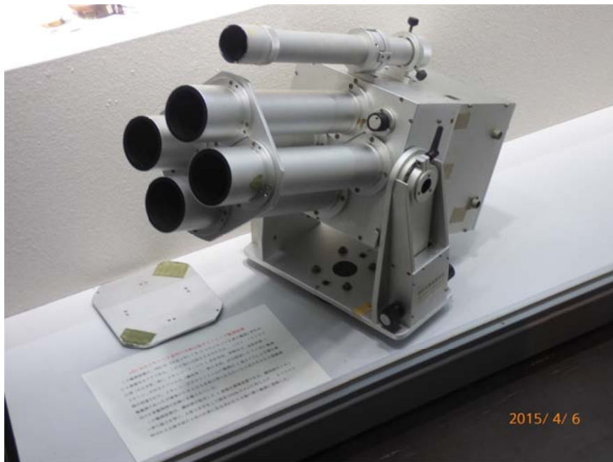
写真 2 天文機器資料館に展示された 4 連偏光撮像装置
