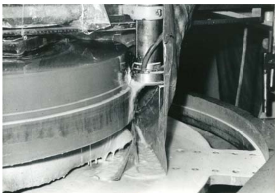
写真 1 主鏡外形仕上げ作業
