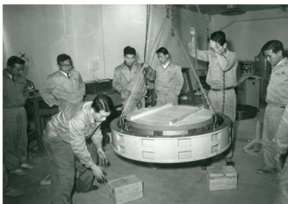
写真 7 主鏡セルへの装着
