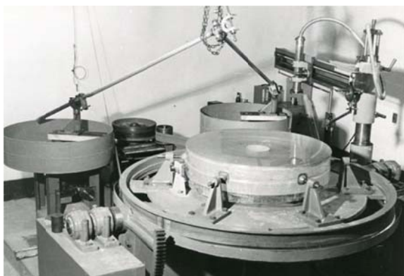
写真 3 研磨台に設置された 91 cm 主鏡
