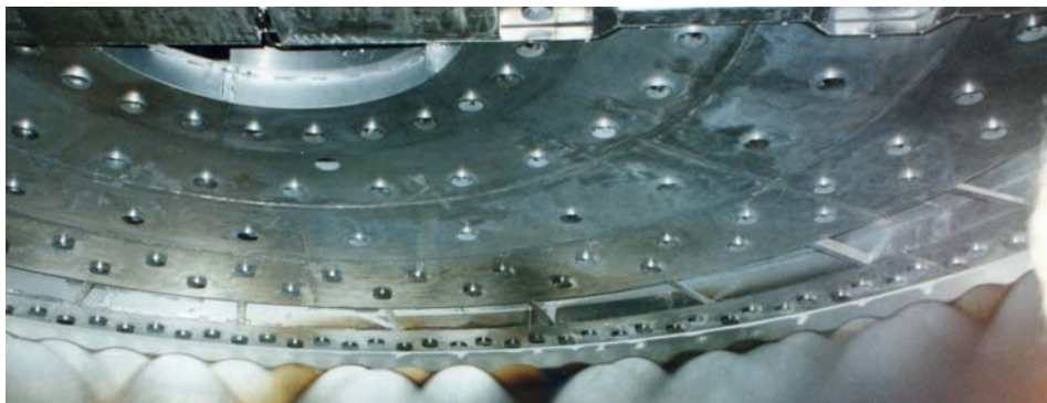
写真 4 ハワイ観測所の真空蒸着装置のフィラメントの配置(一部)
