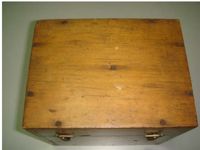
写真 5 鉄のねじくぎが用いられている
