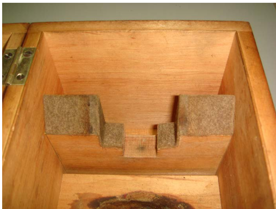
写真8 斜め、凹凸に切られた機械支えの支柱
