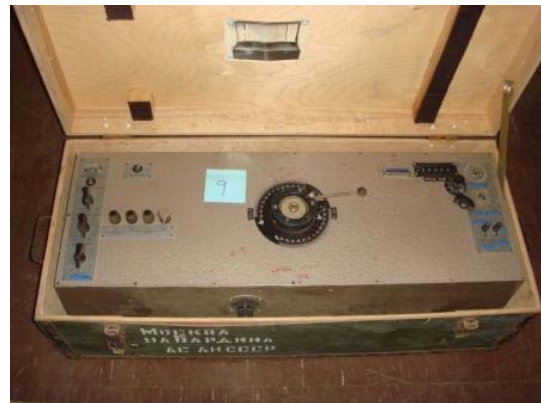
写真 14 制御部・ファインダー架台
