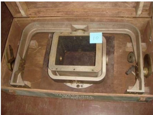
写真 13 トラッキング軸架台
