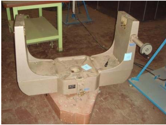
写真 8 両翼のヨークを取り付けた
