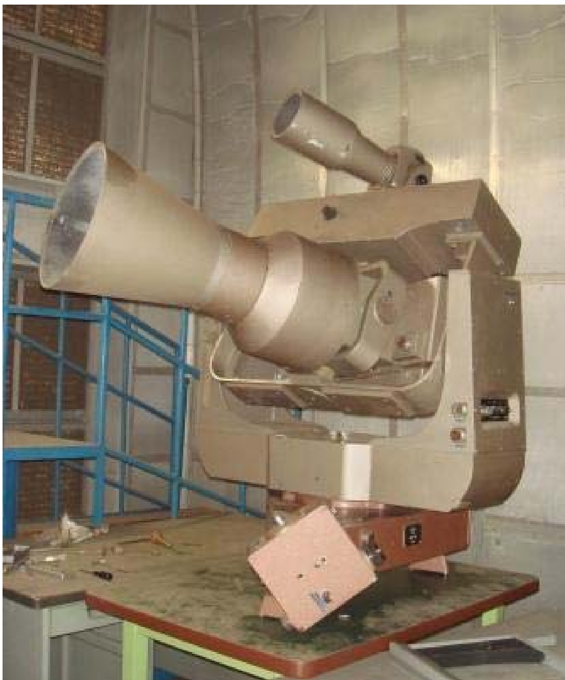
写真 1 組み上がったソ連製人工衛星追跡用 AFU カメラ
