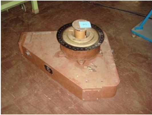
写真 6 AZ 軸を取り付けたベース
