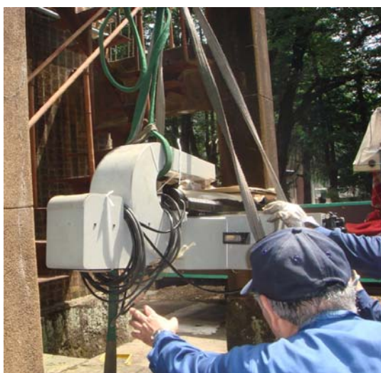
写真3 クレーンで吊られたマン座標測定器とPMCに設置された同機
