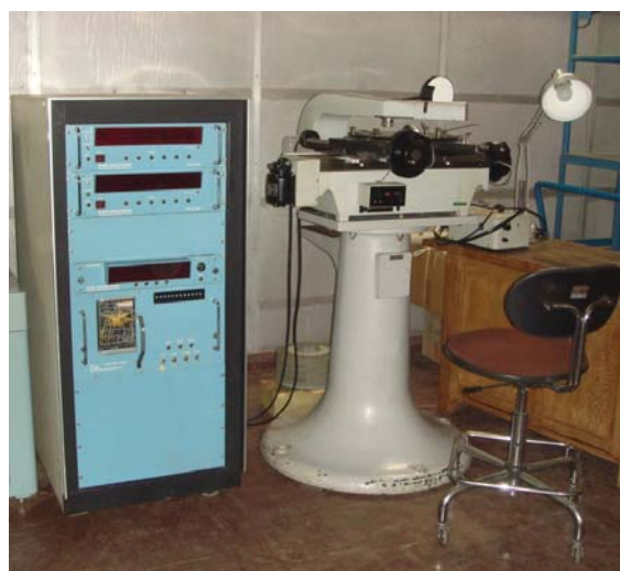
写真3 クレーンで吊られたマン座標測定器とPMCに設置された同機
