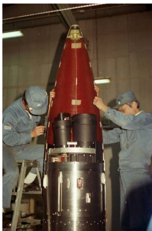
写真 5 ノーズコーン取付け
