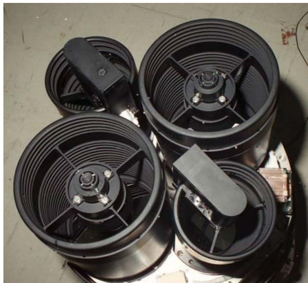
写真 3 黒染めで仕上がった望遠鏡
