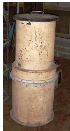
12) シュミットカセのような鏡筒 (レンズ、副鏡あり、しかし主鏡に穴がない)
