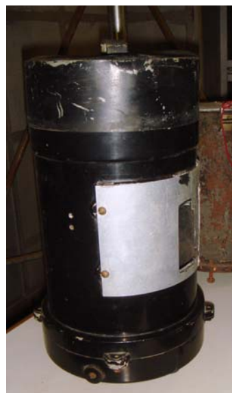
12) シュミットカセのような鏡筒 (レンズ、副鏡あり、しかし主鏡に穴がない)
