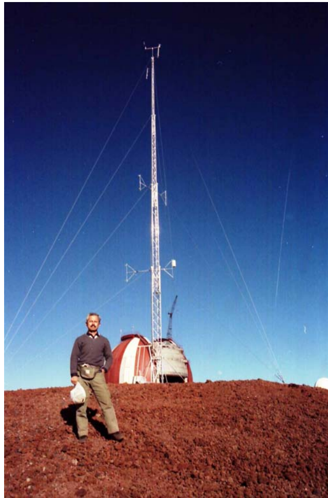
写真2 接地微熱乱流測定用鉄塔
