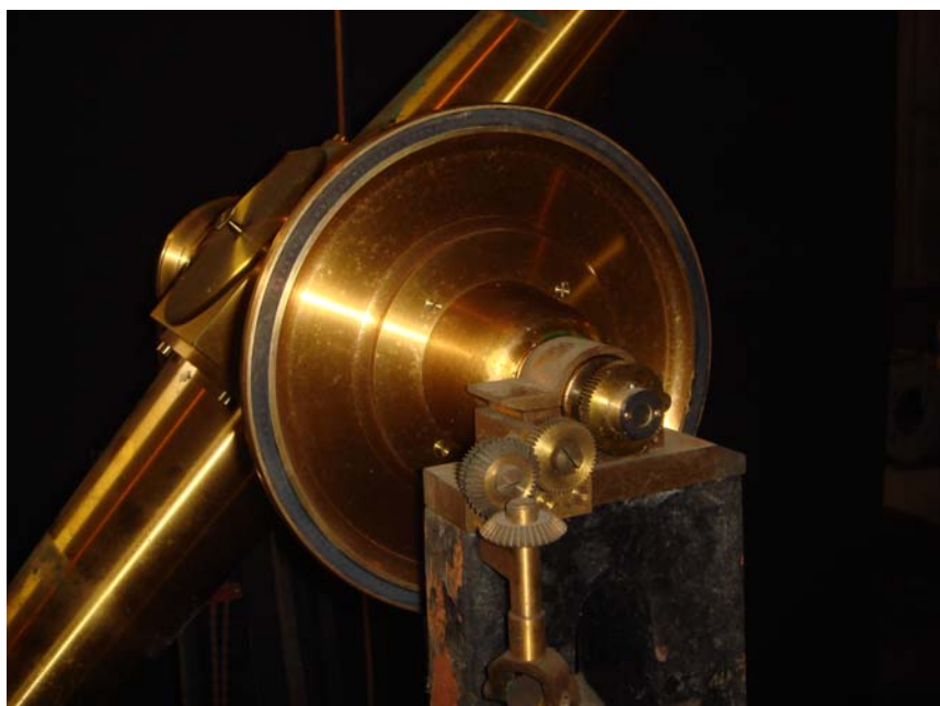
写真5 ギアで駆動できるようになっている
