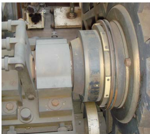
写真3 ゴーチェ子午環軸受けカバー 写真4 プラン子午儀の軸受けカバー 接眼部、マイクロメーターも無事なようだ。写真5がその接眼部である。
