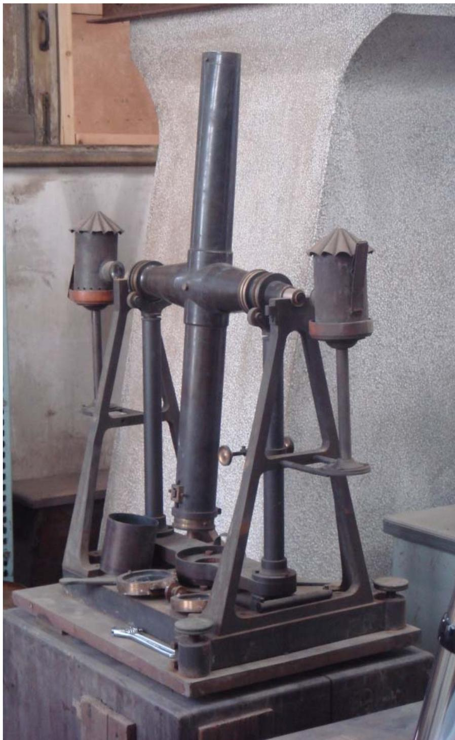
写真7 復元された国立天文台最古の望遠鏡と思われる子午儀
