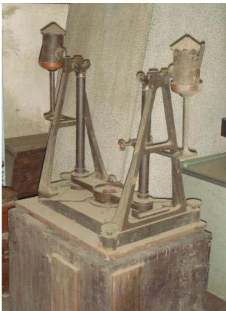
写真2 組み上げられた子午儀の架台
