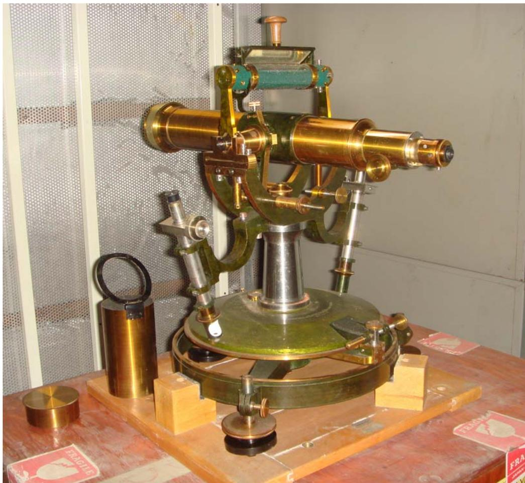
写真3 復元され、展示台の木箱に載せられた27cm 経緯儀
