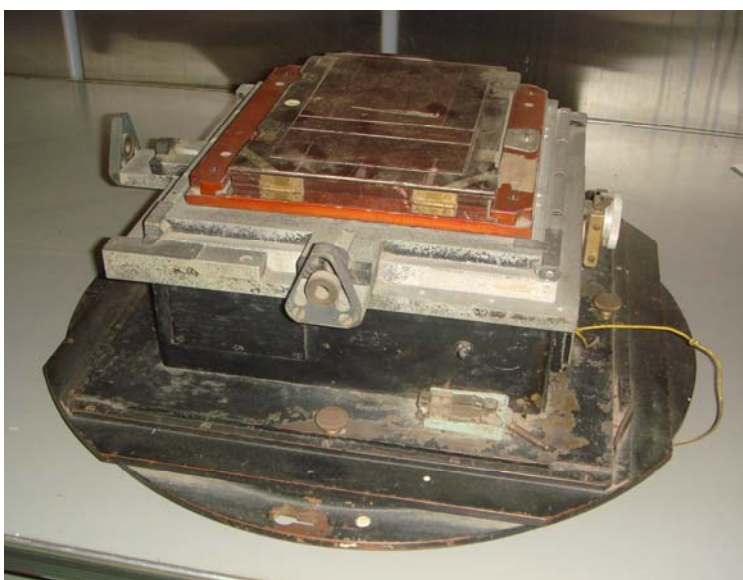
写真 1 ツアイス製の 65cm 屈折望遠鏡用撮像装置
