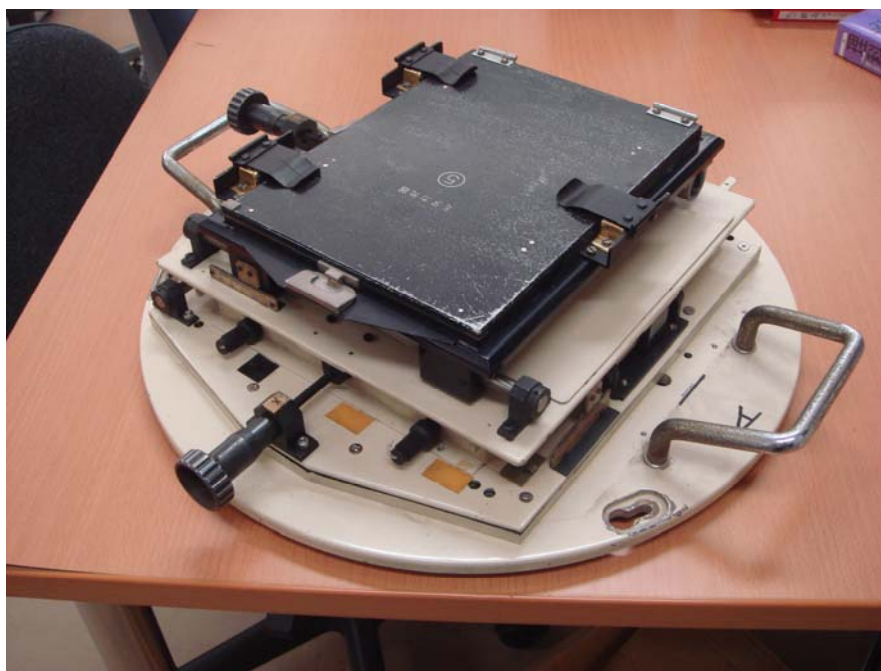
写真5 復元された 65cm 屈折望遠鏡用 2 代目カメラ
