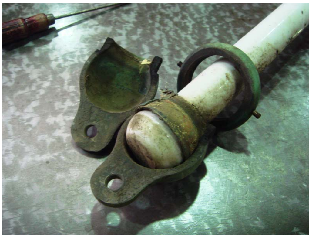
写真 3 二つに割れる鋳物のなかの両端の陶器の丸い部分
