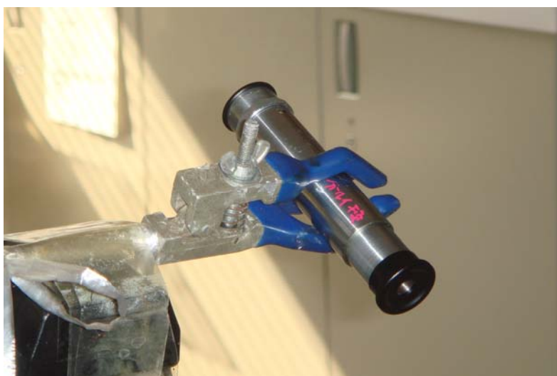
写真3 三脚に固定したDIRECT VISION SPECTROSCOPE
