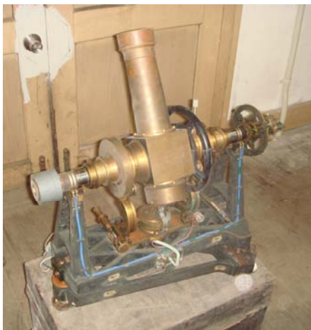
写真 1 国立天文台の 70mm バンベルヒ子午儀
