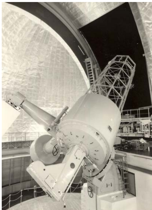
写真2 188cm 望遠鏡とカセグレン分光器 写真3 カセグレン分光器で観測する筆者 この2つあったカセグレン分光器は、一つはガラスプリズムを使ったF10、F3の分光器、
