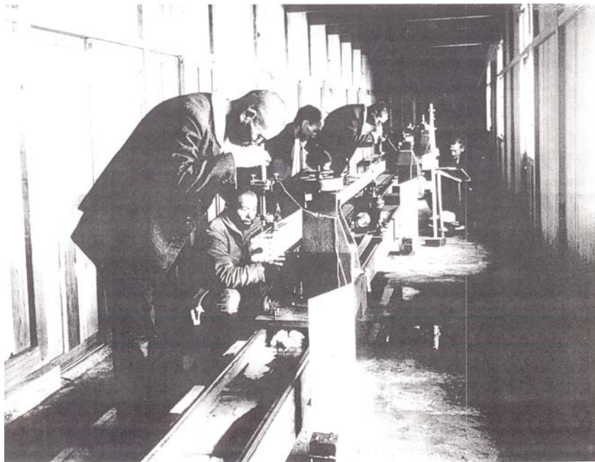
写真 6 菱形基線 基線尺試験室の建物の内部での測定の様子
