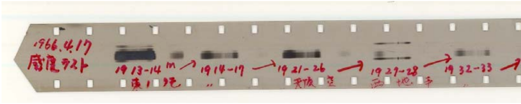
写真3 発光分光器のスペクトルのサンプル 1
