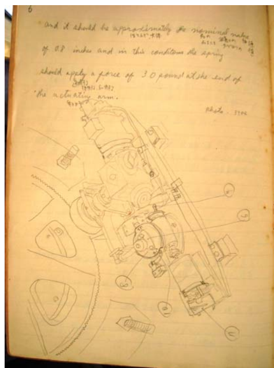
写真5 サイデリアル駆動機構
