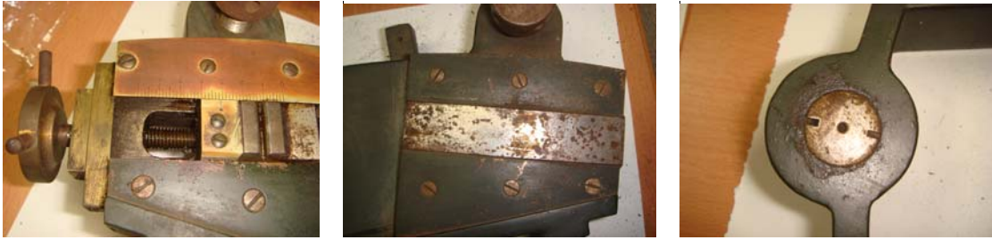
写真 14 それぞれが役目を持っている下部架台の高度軸架台の足受け部
