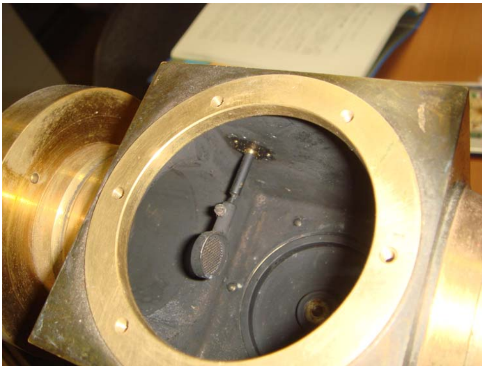
写真8 センターキューブ内の視野照明用光源側にある金網状のもの
