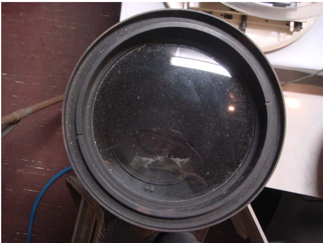
写真4 口径30.48cm 焦点距離351cmのレンズ
