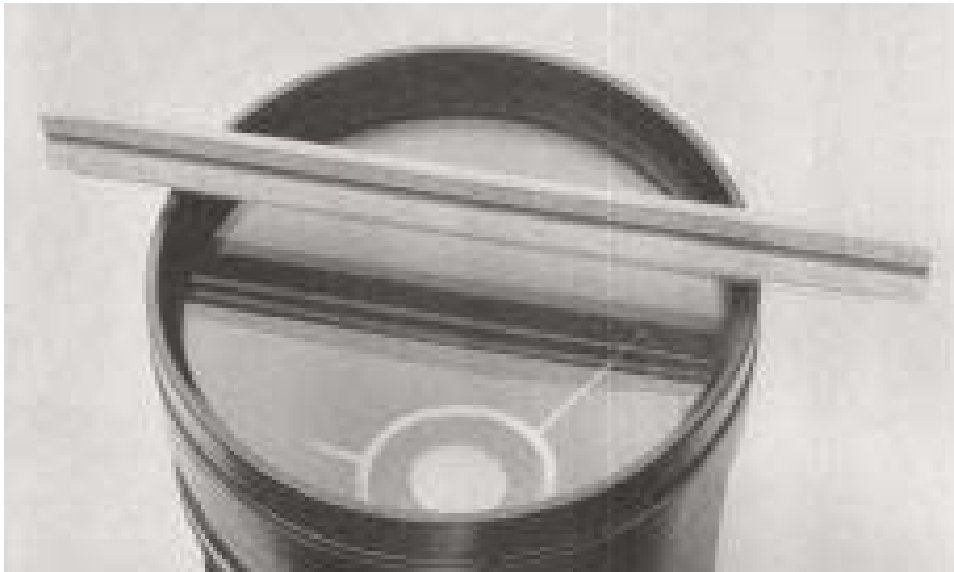
写真2 補正レンズが4次曲面を示している
