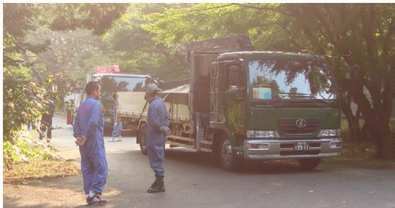
写真3 7トン積みクレーン付きトラック
