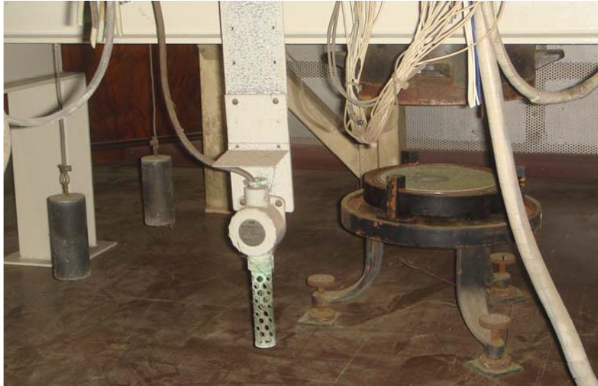
写真7 水銀盤位置から引き上げられた鏡筒下部とバランスウェイト
