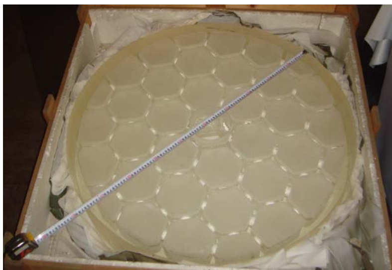
写真 1 直径 95cm、厚さ 18cm のハニカム鏡材
