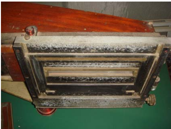
写真9 プレートホルダー取付け部
