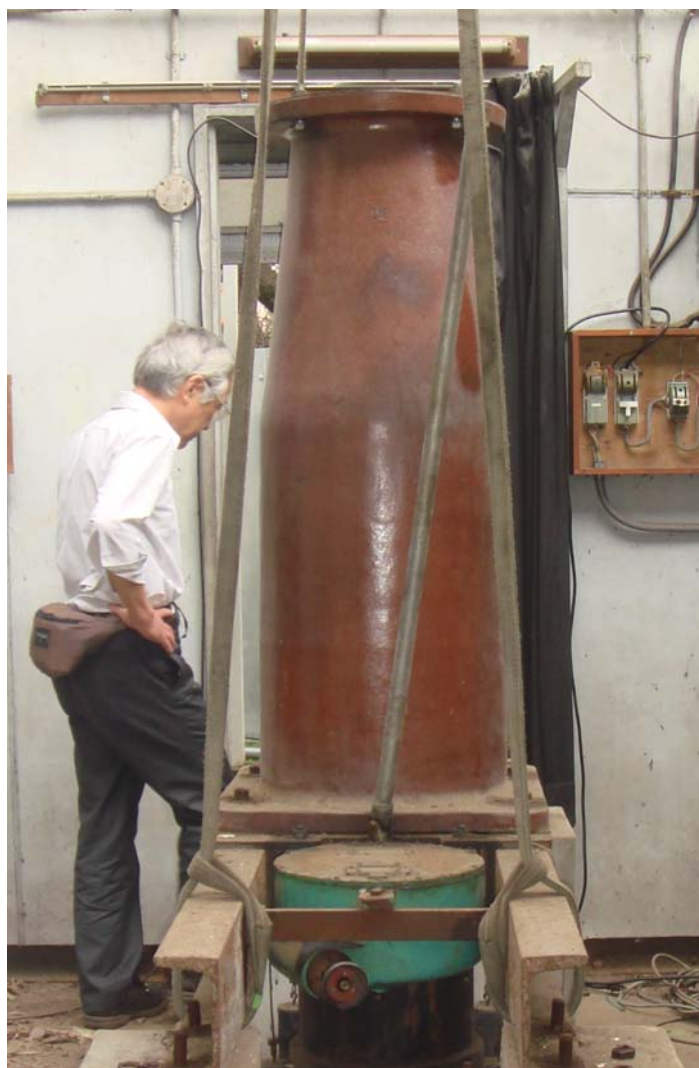
写真2 有田焼の瓶で出来た鏡筒部分
