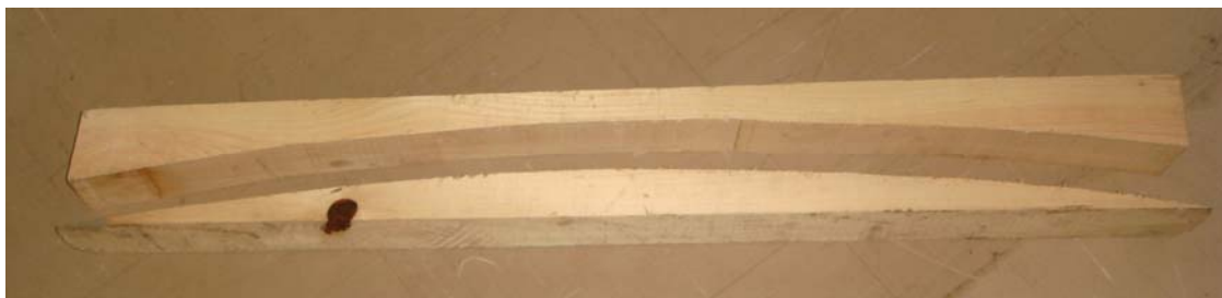
写真2 ドームのカーブに沿った部材を作った残りの木片
