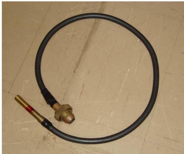
写真3 太陽光球中心の光を導くグラスファイバー
