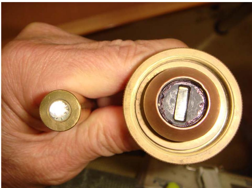
写真4 グラスファイバーの入射、出射口
