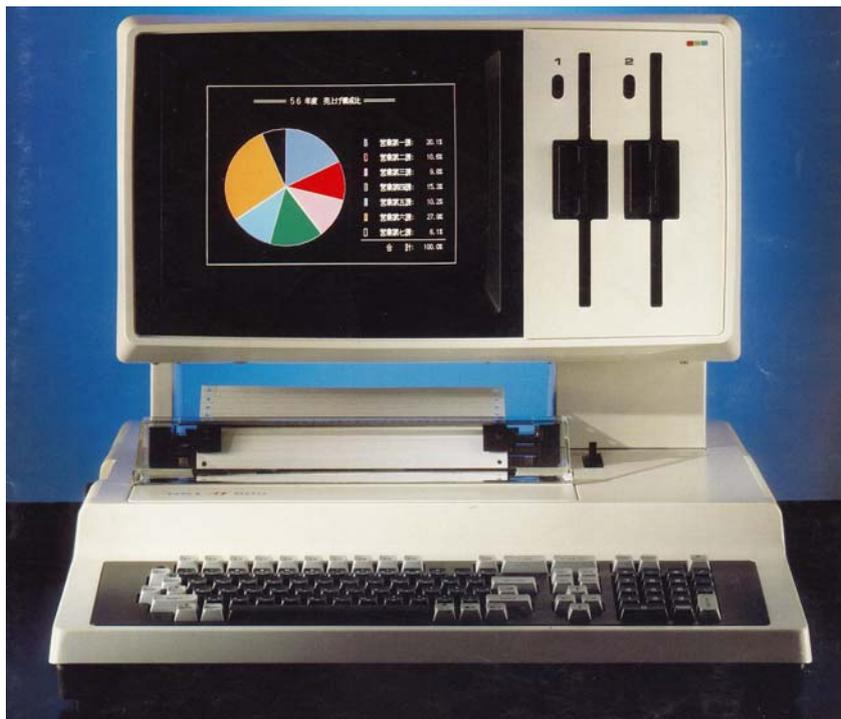
写真2 沖電気の計算機 if800 model130
