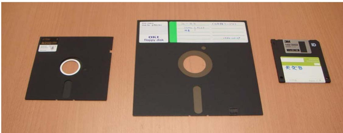
写真1 左から5インチ、8インチ、3.5インチフロッピーディスク
